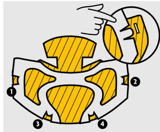
3 Montar el filtro en el marco interno siguiendo el orden que se muestra en la figura.
